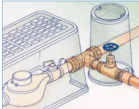
Régions Tempérées : Té à compression en laiton pour le raccordement du système d'arrosage à l'alimentation en eau de la maison.
