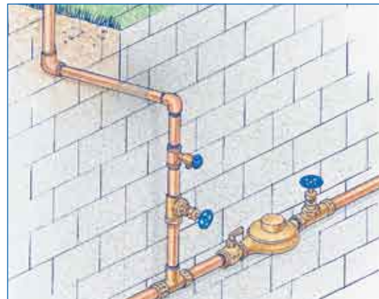
Régions très Froides: si le point de branchement est en sous-sol, prévoyez un point de vidange immédiatement en aval de la vanne à boisseau isolant le système d'arrosage, avant les premiers grands froids.
