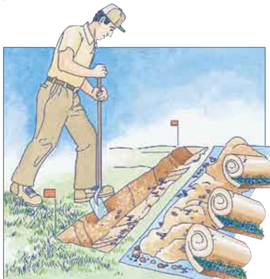
Placer d'abord un plastique puis enlever la terre et creuser des tranchées entre 20 cm et 60 cm de profondeur pour la canalisation principale et de 15 à 25 cm pour les canalisations latérales.
