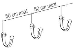
Utiliser les vis inox fournies pour fixer les crochets bandeaux sur le support.
